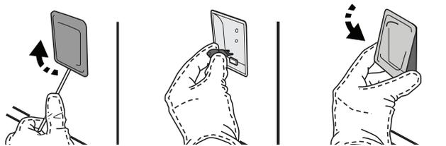
Зверніть увагу: Використовуйте лише галогенові лампи типу G9, 20-40 Вт/230 ~ В, Т300°С. Лампа, що використовується у виробі, розроблена спеціально для побутових електричних приладів і не підходить для побутового освітлення приміщень (Постанова ЕС 244/2009). Лампи можна придбати в Центрі післяпродажного обслуговування.
