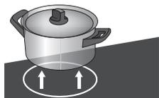
Если в течение 1 минуты после включения и установки степени нагрева на конфорку поставить подходящую посуду, конфорка начнет работать с установленной мощностью. Если снять посуду с конфорки, подача энергии прекратится.
