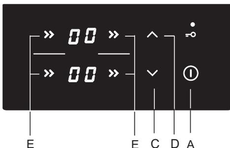
После включения варочной панели в течение 10 секунд включите необходимую конфорку сенсором Е. Сенсорами С и D выбранной конфорки установите степень нагрева. Если первым нажать сенсор С, сразу установится мощность 9. Если первым нажать сенсор D, установится мощность 1.
