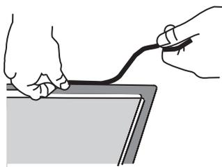
Выведите присоединительный кабель вниз через монтажный проем. Установите варочную панель по центру монтажного проема. Подключите прибор к электросети (см. раздел «Подключение к электросети») и проверьте его работу перед прокладкой герметика.
