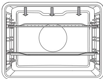
При **большом гриле** включаются верхний нагревательный элемент и инфранагреватель, расположенные под потолком духовки.
