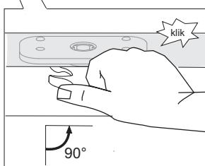
Пальцем отодвните замок вправо на 90° до щелчка. Замок дверцы заблокирован (в нерабочем состоянии).
