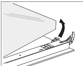
**2** Возьмите стекло дверцы за нижний край, немного приподнимите, чтобы оно освободилось из фиксаторов, и снимите.
