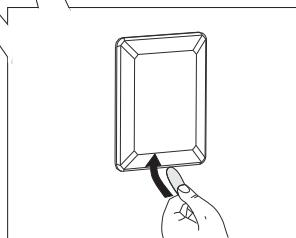
**1** С помощью отвертки снимите крышку.
