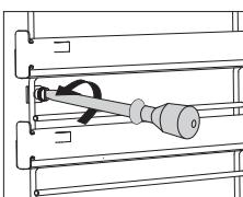
**1** Открутите винт с помощью отвертки.
