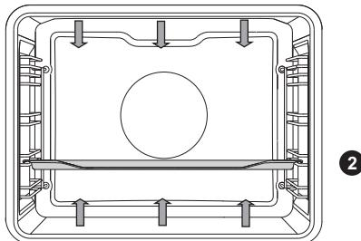
Верхний и нижний нагревательные элементы равномерно излучают тепло внутрь духовки.
